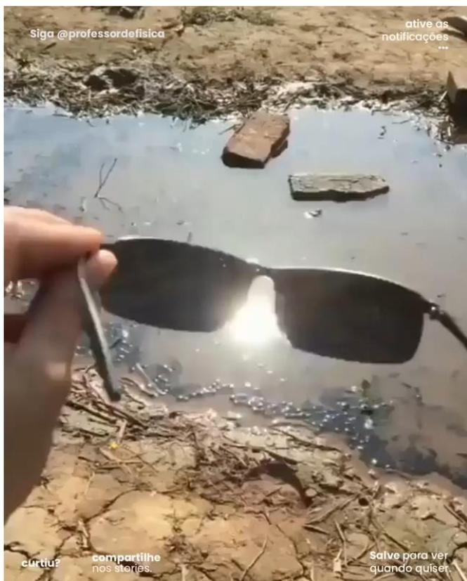
(ENEM) Nas rodovias, é comum motoristas terem a visão ofuscada ao receberem a luz refletida na água empoeçada no asfalto. Sabe-se que essa luz adquire polarização horizontal. Para solucionar esse problema, há a possibilidade de o motorista utilizar óculos de lentes constituídas por filtros polarizadores. As linhas nas lentes dos óculos representam o eixo de polarização dessas lentes.
